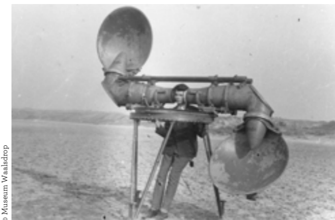
Dispositif de localisation sonore mis au point à la fin des années 1920 pour détecter les avions
