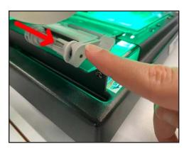
2/ Les taquets (à droite et à gauche du lecteur) guident la bobine : il faut donc les mettre dans la position adaptée à la taille de la bobine, c'est-à-dire vers l'arrière pour une bobine de 35 mm.
