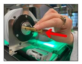
1/ Tout d'abord, il faut installer l'adaptateur sur l'enrouleur de gauche. Placez-le dans la fente et vérifier qu'il n'y a pas d'espace entre l'enrouleur et l'adaptateur.
